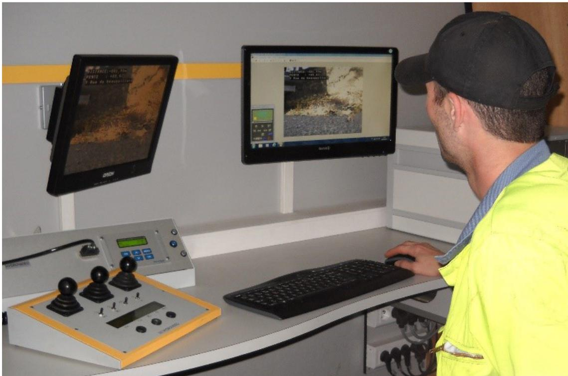
Exemple d'inspection télévisée avec véhicule spécialisé
