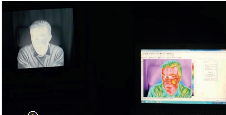
La thermographie est utilisée depuis 6 ans par Spincontrol pour mesurer les sensations de chaleur ou de froid induites par les produits combattants par exemple le feu du rasoir ou les jambes lourdes. La caméra réalise une cartographie infrarouge de la peau.
