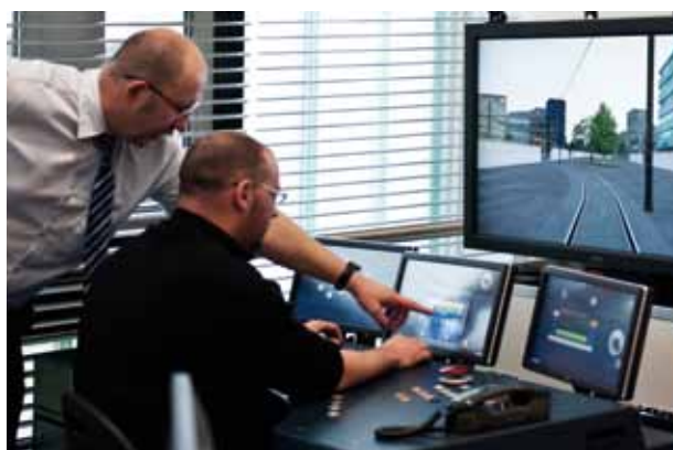
Arnaud apprend à « conduire » le tram sur un simulateur. La voie se déroule devant lui et il dispose d'écrans de contrôle comme sur le tramway. Le formateur s'est déplacé pour lui expliquer une procédure.
