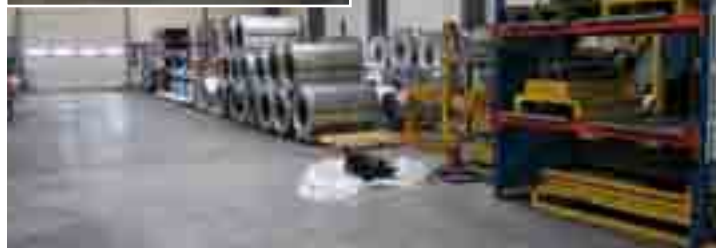
L'acier arrive en rouleau, il est déroulé et mis en forme pour la fabrication des lanterneaux. Hexadome développe aussi une activité commerciale de façonnage, en fournissant des pièces sur mesure pour toitures et lanterneaux. (15 % de l'activité).
