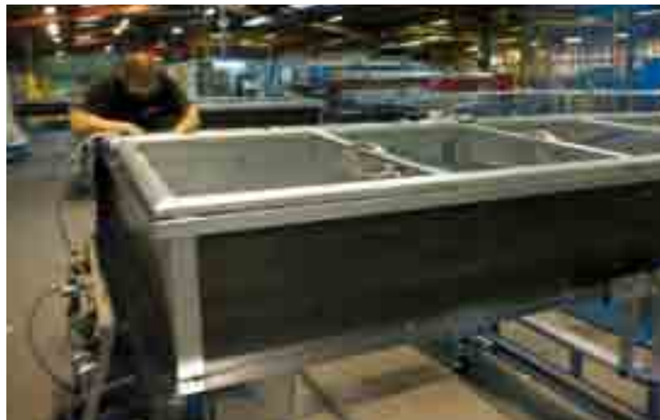
Finition d'un lanterneau dans l'atelier de façonnage
